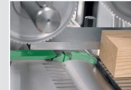
Füge-/Falzeinrichtung – Abrichten und Fügen auf der 1. Spindel
