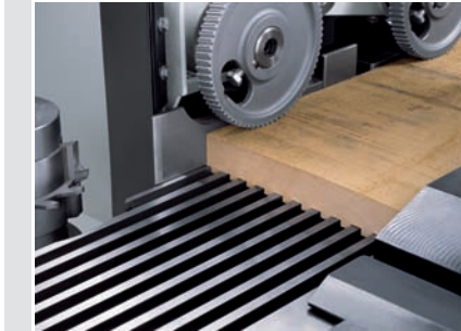
Nutenführung: exakte Parallelität – auch bei kurzen, krummen Teilen
