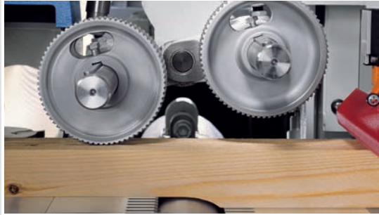
Pneumatisch »hoch-tief« getaktete Einzugswalze für exaktes Abrichten
