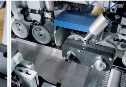
Kurzteile-Walzenpaket: sicherer Transport bis 45 cm (Baureihe 017)
