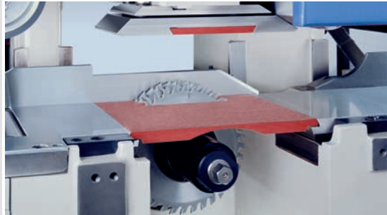
Tischplatten/Druckschuh-Einlegesegmet: geschlossene Auflage im Sägebereich
