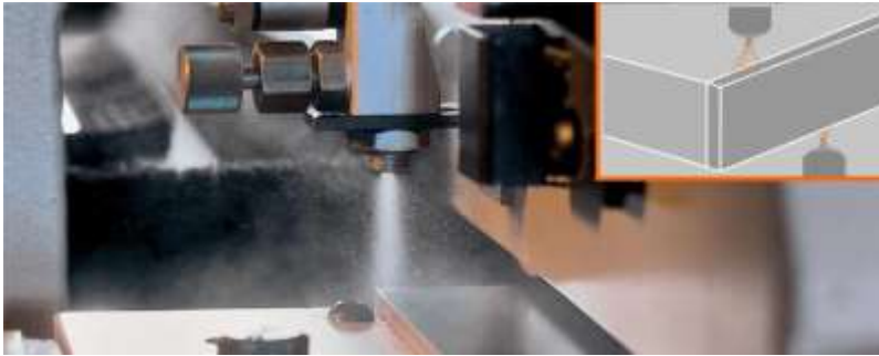
Sprüheinrichtung (Antistatik-Kühlmittel) nach Druckwerk Einsatz mit Antistatik-Kühlmittel
