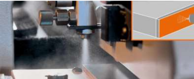
Sprüheinrichtung (Trennmittel) nach Druckwerk zur Benetzung der Kante mit Gleitmittel empfehlenswert für die Bearbeitung von Hochglanzkanten
